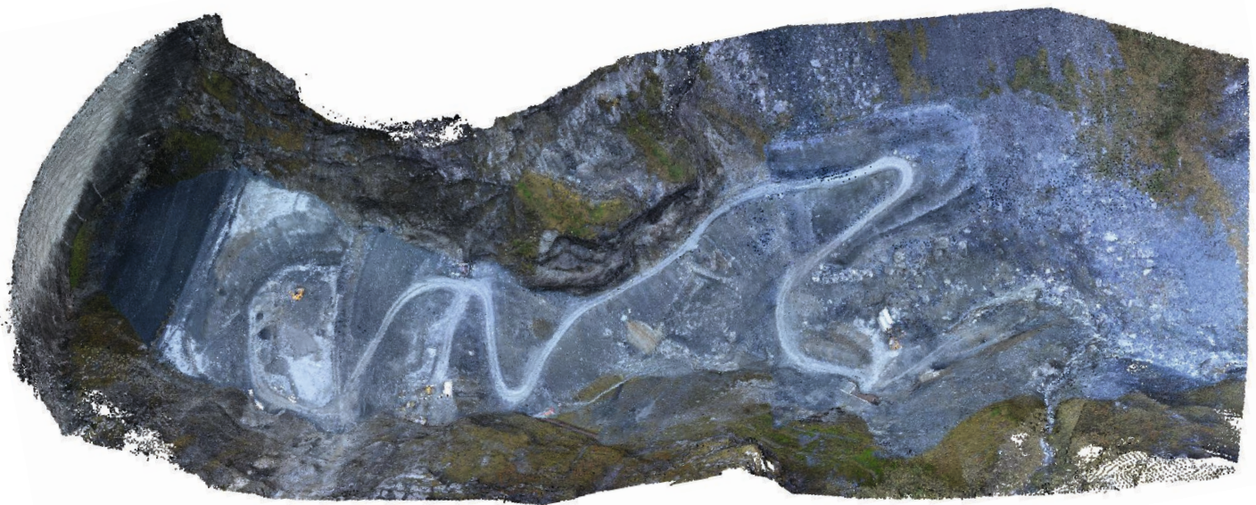
■ Nube de puntos generada en la zona con una precisión máxima de un centímetro.
