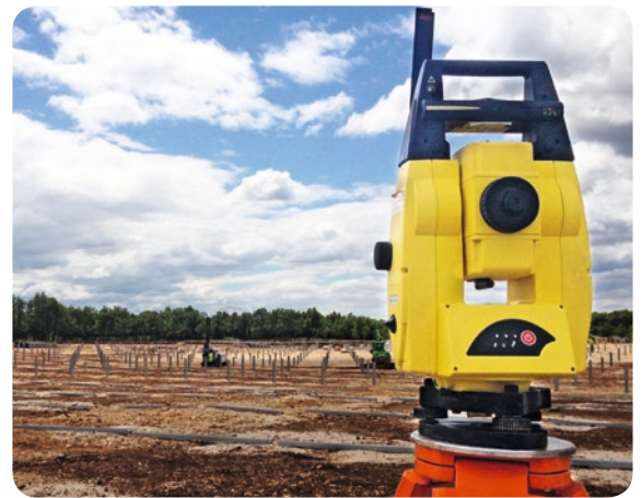
■ Replanteo usando la Leica iCON robot 50
