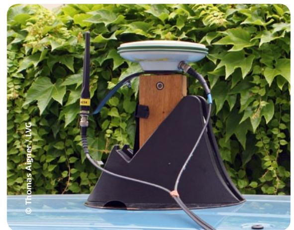
■ Configuración de antena GSM y GNSS
