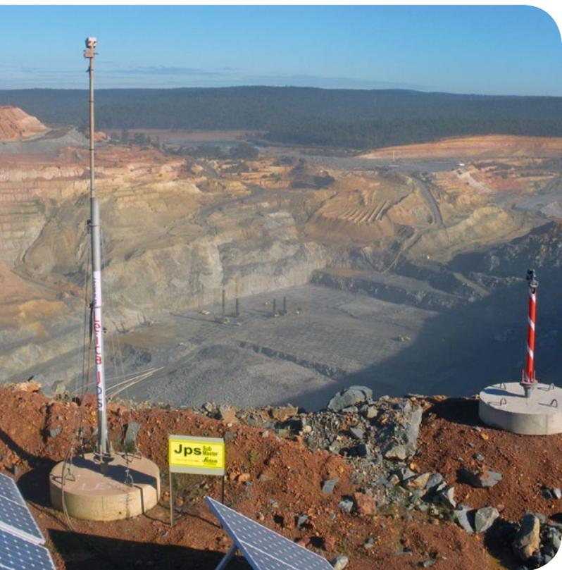
■ Leica Jps instalado al borde de una mina.
