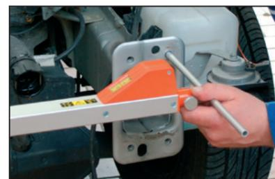
Las puntas de medición que forman parte del equipo standard también permiten mediciones en puntos de difícil acceso. Incluso es posible determinar rápido y sencillamente distancias entre dos puntos no situados en el mismo nivel. Los conos de medición que también se suministran de serie sirven para medir fácilmente distancias entre taladros.
