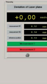
El dispositivo de **calibración Laser Calibration 2** de Nedo destaca por contar con una interfaz de usuario que se puede manejar de forma intuitiva. La exactitud del **láser rotatorio** inspeccionado se puede leer directamente en mm/m.
