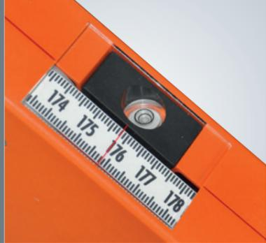
En el indicador analógico del **láser mEssfix-S** de Nedo se puede leer con facilidad la diferencia de altura entre la línea cero del receptor láser y el punto de apoyo del **láser mEssfix-S**.
