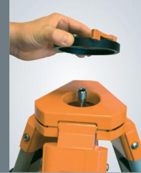
En el reequipamiento se fija la placa de adaptación Quick-Fix con el tornillo de sujeción del trípode y el adaptador redondo Quick-Fix en el instrumento.
