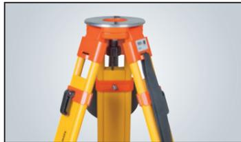
Los geodestas, no obstante, prefieren trípodes de madera para instrumentos de alta precisión. En comparación con los trípodes de aluminio, los de madera presentan un mejor comportamiento de amortiguación en el caso de vibraciones.
