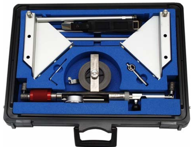
Fig.: Cinta de convergencias con cinta métrica y comparador, marco de calibrado y herramientas de montaje, en su maletín de transporte.
