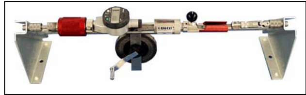
Fig.: Cinta de convergencias con comparador digital sobre el marco de calibrado.
