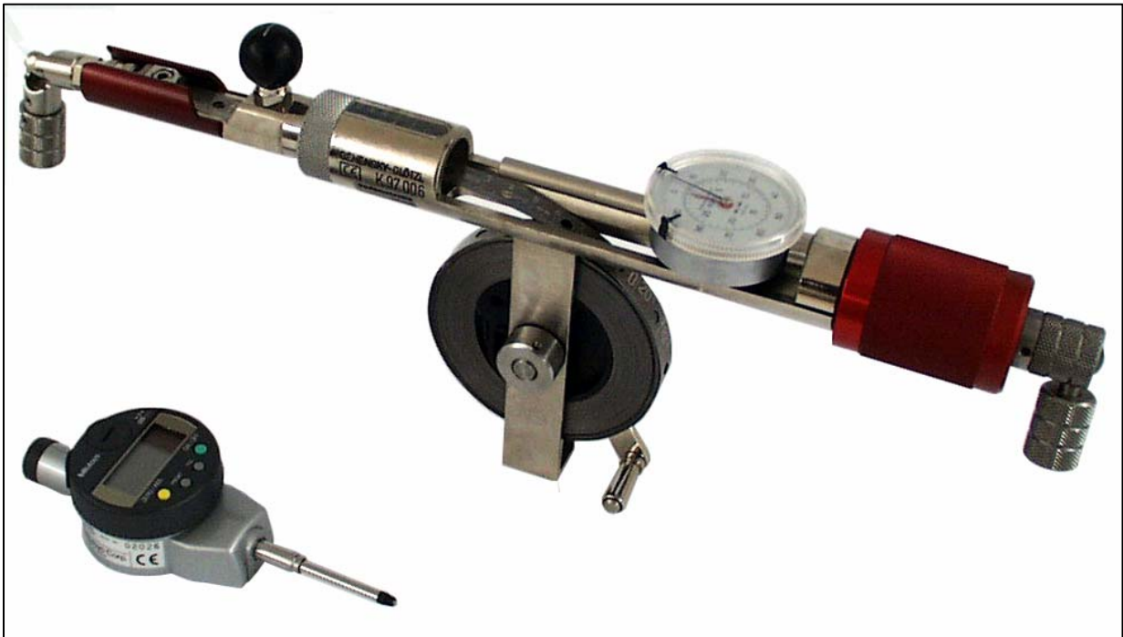
Fig.:Cinta de convergencias equipada con comparador mecánico, comparador digital a la izquierda. .
