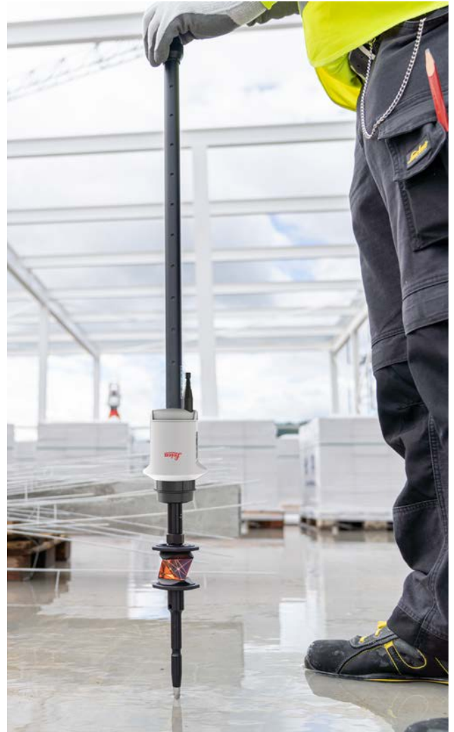
Figura 3: Replantee puntos con la máxima precisión en el modo de inclinación invertida con una mínima altura del prisma.
