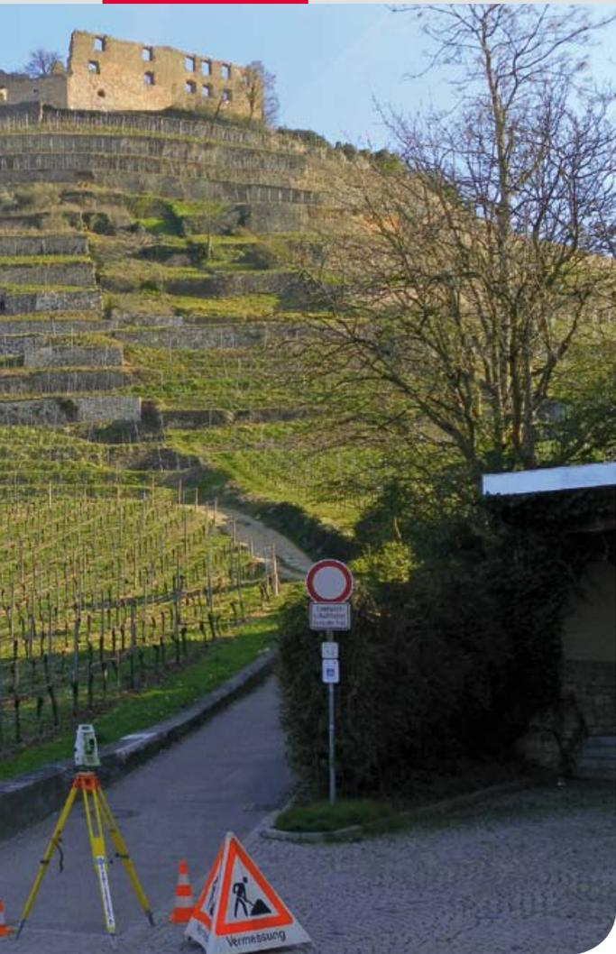
La red de deformación se compone de seis puntos estables (puntos de referencia) y 72 puntos objeto (puntos de no referencia). Se apoya en puntos de referencia catastrales, en puntos de cambio de la altimetría, así como en nuevos puntos fijos en bordillos y en edificios con pernos de espiga para prismas de precisión. La precisión de posición requerida en la red no delimitada se preestableció en  $\pm 5$  mm.
