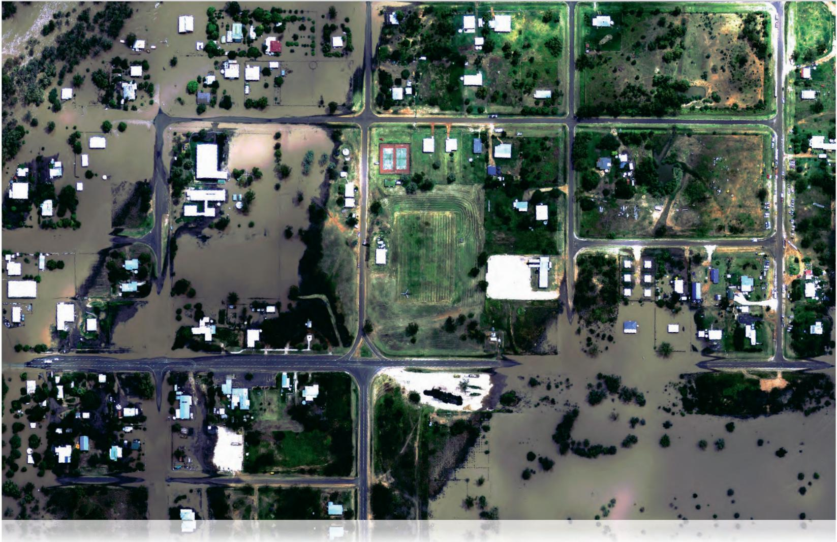
de los datos, para poder enviar cuanto antes a sus múltiples clientes la información obtenida. La adquisición de los datos gráficos se realizó con el sensor digital de aerofotografía Leica ADS40. Este sensor no sólo adquiere imágenes digitales, también es capaz de generar modelos de superficie de las zonas. En comparación con el procedimiento anteriormente empleado por el ejército australiano para la adquisición de datos gráficos, esta función representa un salto cuántico técnico.
