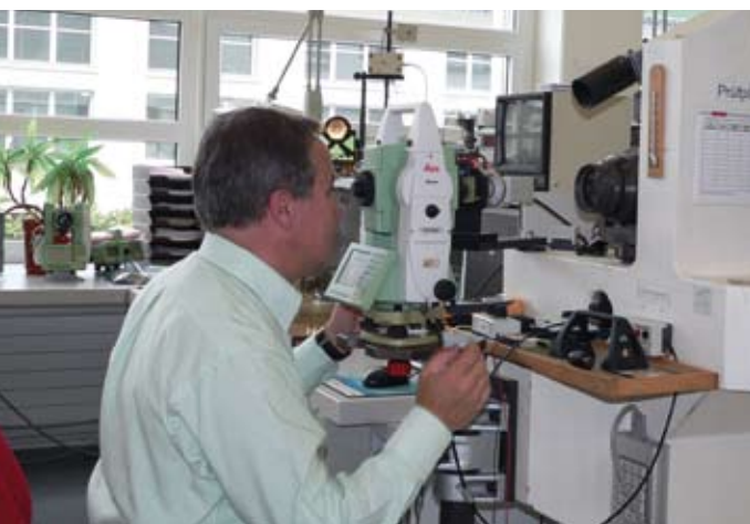
■ El empleado del CTS Guido Grossmann durante el ajuste de una estación total Leica TCP1205+.
