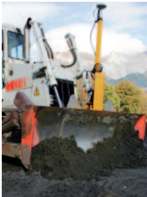
Foto de arriba: La máquina de la obra está equipada con un sistema Leica Dozer que determina la posición 3D de la pala en tiempo real al centímetro. El conductor de la máquina recibe todos los detalles del guiado directamente del sistema.
