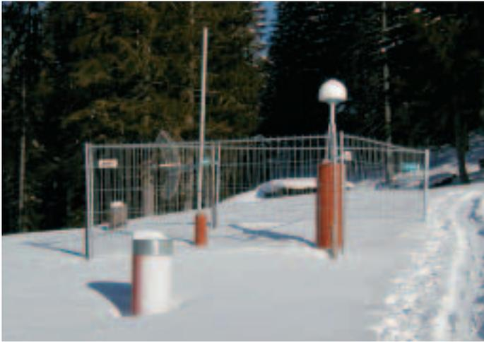
**(Arriba): Estación GPS permanente con antena LAN inalámbrica**
