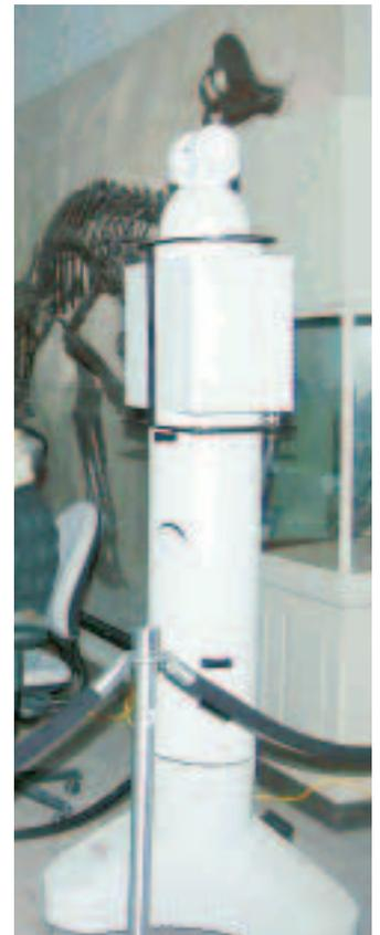
*(A la derecha): Los radares por láser coherente LR200 tuvieron que ser colocados sobre unas torres para poder desplazarlos alrededor del esqueleto*
