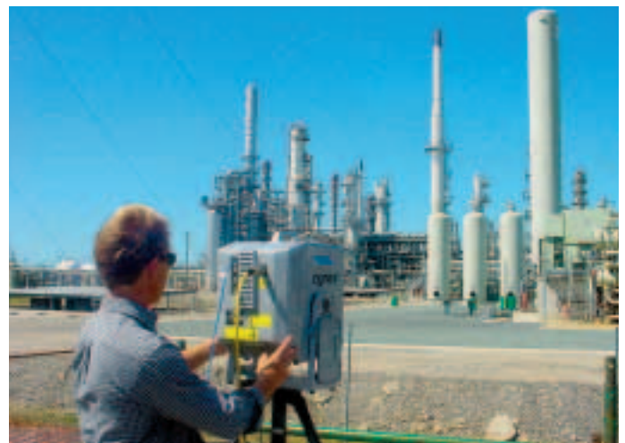
Uno de los siguientes proyectos de North Surveys fue la documentación de tuberías en la refinería de BP en Queensland, con el Cyrax 2500.
