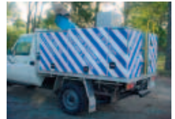
North Surveys ha diseñado un camión especial para trasladar el escáner Cyrax montado en un mástil extensible.
