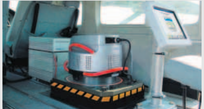
El Leica ADS40 de Leica Geosystems es el sensor digital de imágenes aéreas más potente del mundo. Capta el terreno y sus objetos para estudios medioambientales, creación de modelos y trabajos cartográficos, ofrece una resolución por píxel de 15 cm del terreno, graba en un total de 10 canales incluido el infrarrojo y permite las tomas hacia adelante, verticales y hacia atrás para el análisis tridimensional.
