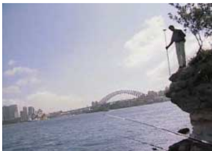
La fase de toma de datos abarcó mediciones de control con la ayuda de teodolitos electrónicos, el posicionamiento por GPS de primer y segundo orden, así como ajustes. Por toda el área se colocaron varios centenares de estaciones de control de segundo orden, integradas en la red estatal de control terrestre y aérea, y se midieron más de un millón de puntos para estructurar el modelo.
