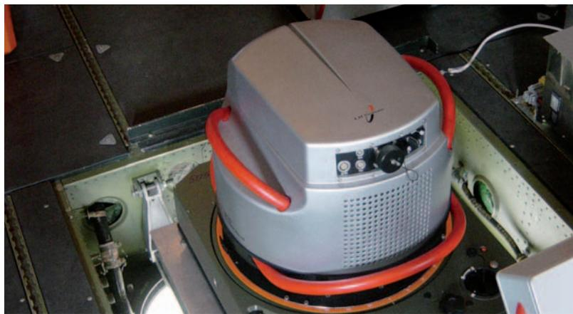
■ Un sensor aerotransportado Leica ADS40, montado en el avión.
