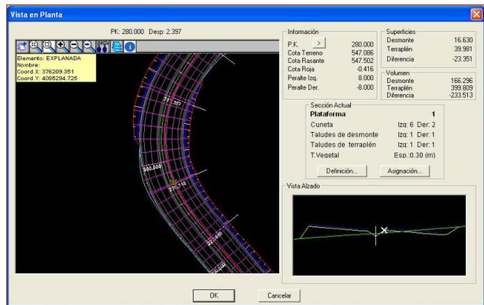
Creación automática de secciones y asignaciones a eje a partir del dibujo en planta.
