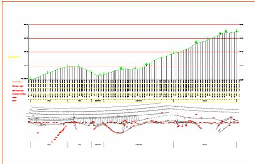
Visualización dinámica de ficheros de tramos, con perfil rápido, perfil longitudinal y obtención de la cota de un punto.
